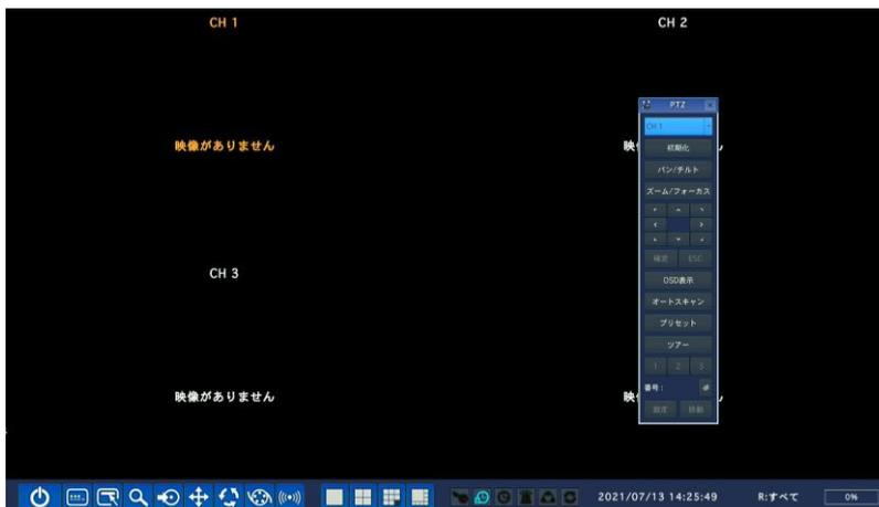
PTZコントロールパネルのボタンの説明ライブ画面の下段
